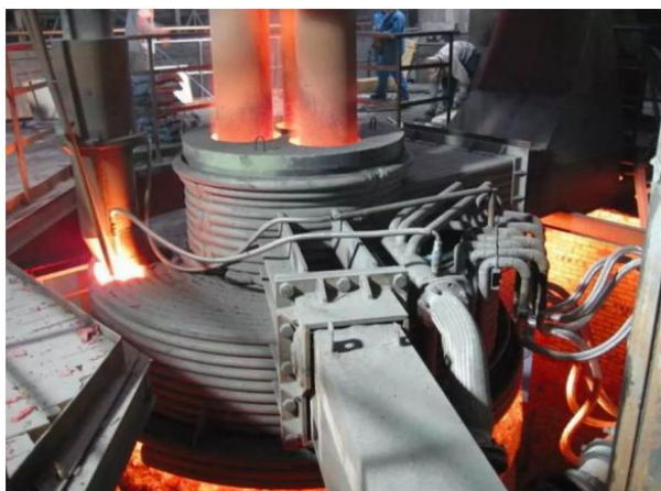
Рисунок 1 – Механизм подъема и поворота свода и электродов агрегата «печь-ковш» [3]
